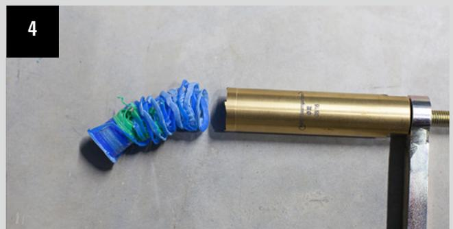
Entfernen der Bohrrückstände aus dem Bohrwerkzeug
