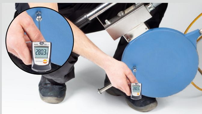
Temperaturmessung an der aquatherm Stumpfschweißmaschine
