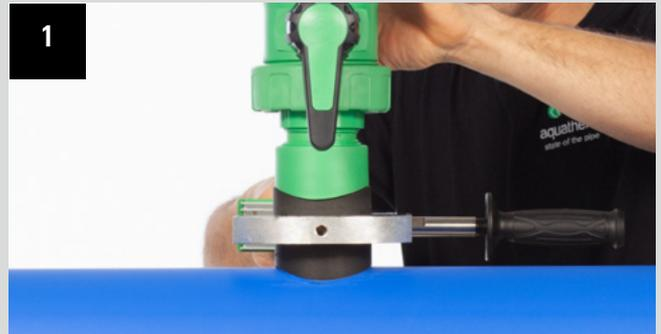
Aufschweißen des Aufschweißsattelsets auf das Hauptrohr
