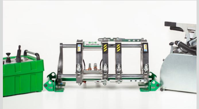
Funktionen der Schweißmaschine kontrollieren und diese aufheizen
