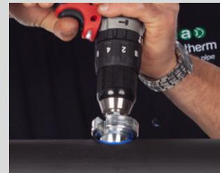
Entfernen der Sauerstoffsperrschicht beim aquatherm blue pipe OT-Rohr bzw. der UV-Schicht beim aquatherm UV-Rohr
