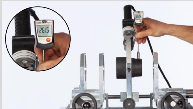
Temperaturmessung an der aquatherm Schweißmaschine
