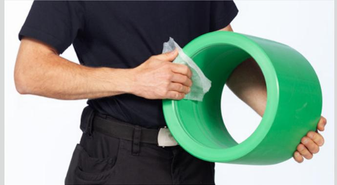
Reinigen der E-Muffen Innenfläche mit einem fusenfreien Tuch oder Papier. **Unmittelbar vor der Schweißung** erneut eventuell aufgetretene Feuchtigkeit entfernen.
