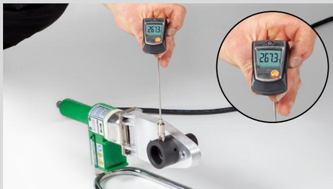
Temperaturmessung am aquatherm Handschweißgerät (800 W)
